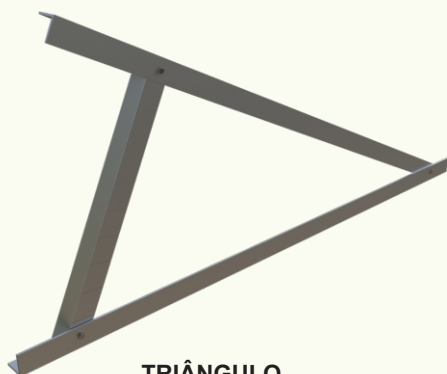
TRIÂNGULO COD.: IZI610 Material: Alumínio 6060-T5 Inclinação: 25° (com marcação para furos e cortes a cada 2,5° até 5°).
